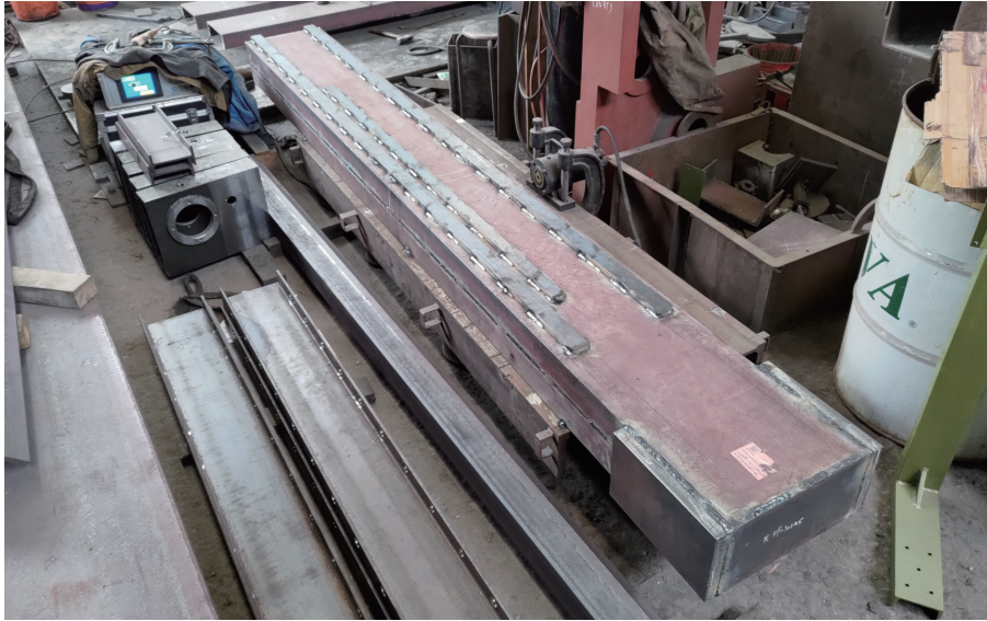
工件點焊固定在振動平台進行振動加工
